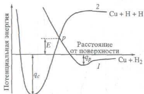
Рис. 2.10. Потенциальные кривые физической адсорбции H_2 на Cu (1) и диссоциативной хемосорбции H_2 (2)
